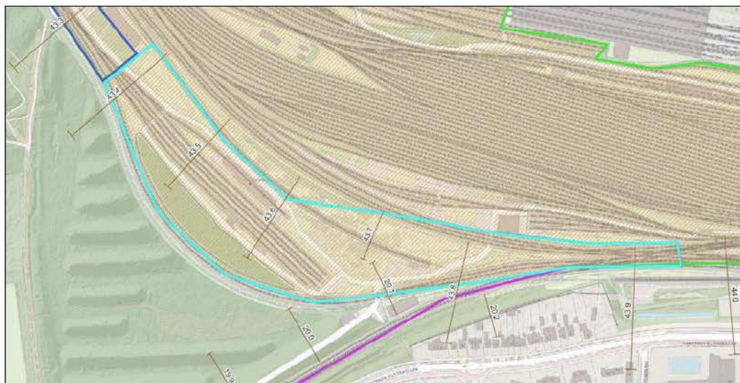
Figuur 6.5 In het lichtblauw omliggende gedeelte worden 24/7 werkzaamheden uitgevoerd. Aan de zuid- en westkant van het emplacement worden schermen geplaatst. Bron achtergrond: PDOK.
