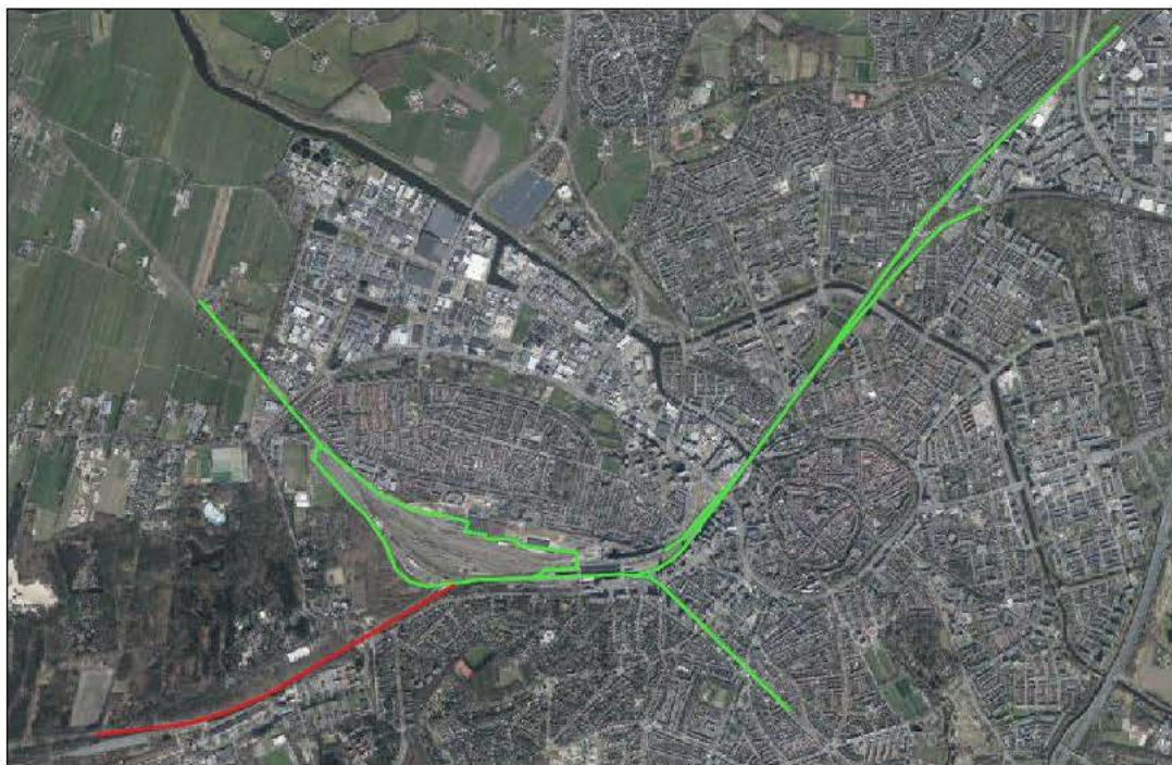
Figuur 6.1 Tracé waarlangs mitigerende maatregelen voor zandhagedis en ringslang worden getroffen (rood gemarkeerd). Werkzaamheden binnen het groen aangegeven deel van het projectgebied kunnen uitgevoerd worden zonder aanvullende maatregelen ter bescherming van reptielen. Bron achtergrond: PDOK.
