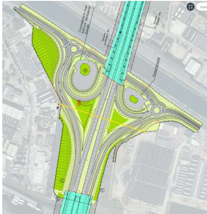
Figuur 6. De toekomstige situatie van het projectgebied. De grijze strepen geven aan dat het om een schuin talud gaat.
