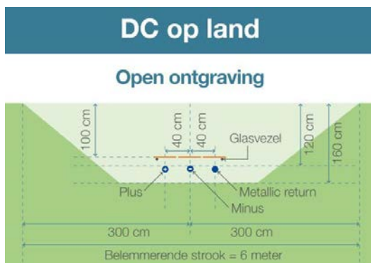
Afbeelding 3.5 Dwarsdoorsnede DC-verbinding op land
