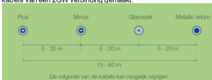
Afbeelding 31b. Een 2 GW-kabelsysteem HDD-kruising primaire waterkering
