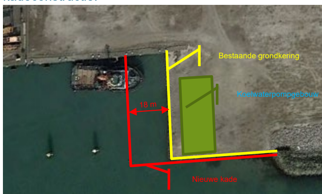
Figuur 1: Indicatieve locatie koelwaterpompgebouw met nieuwe kadeconstructie
