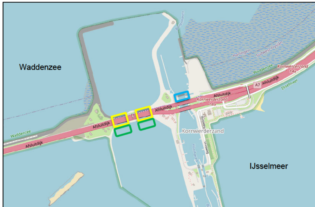
Figuur 1.3 Planlocaties van de bestaande spuigroepen (geel) en de flexibele bodembescherming (groen) bij spuicomplex Kornwerderzand en de keersluis Kornwerderzand (blauw) (kaartondergrond: OpenStreetMap ).
