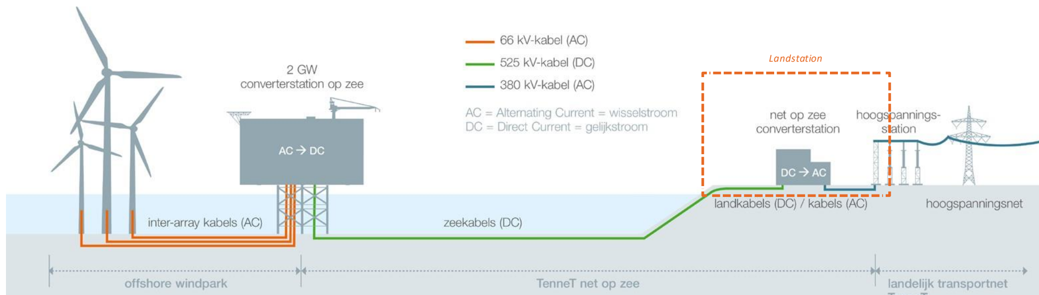
Afbeelding 1 Tracéschema wind op zee. bron: TenneT
