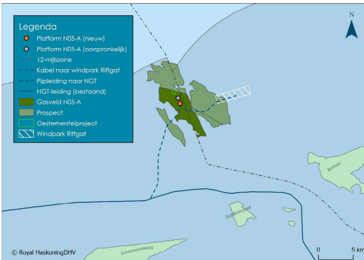
Figuur 1-1: Oorspronkelijke en nieuwe locatie van het productieplatform, inclusief de ligging van de gasvelden en de nieuwe tracés van de gasleiding en de kabel naar windpark Riffgat.
