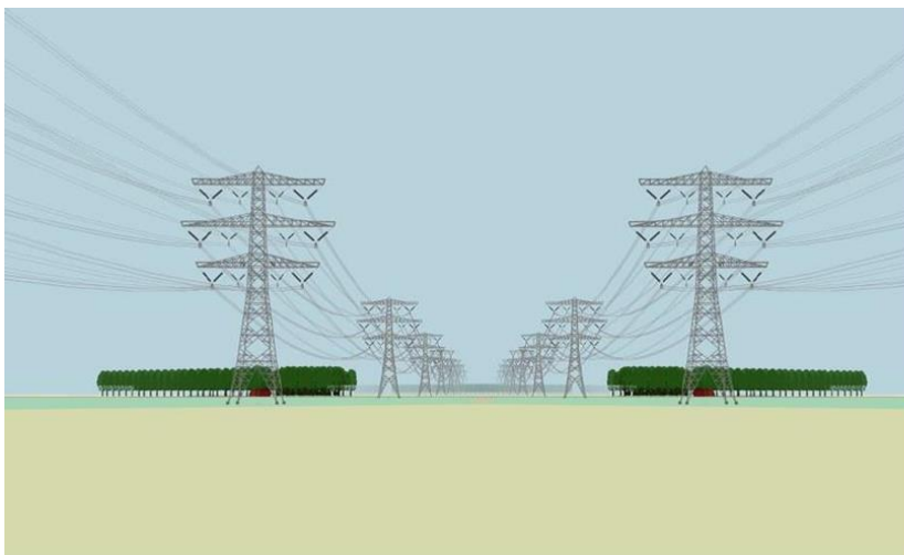
2 vakwerkmasten met 4 stroomcircuits
