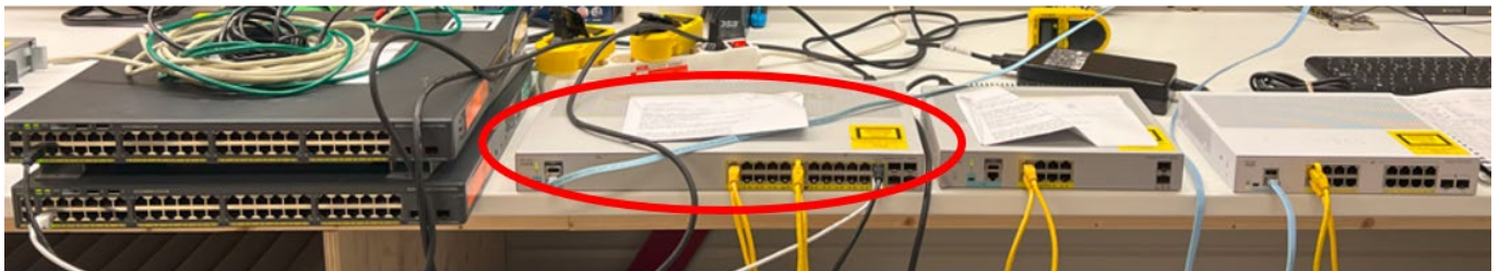
figuur 2: foto van de test situatie "sternetwerk", alle getoonde apparatuur sluit aan op de, rood omcirkelde centrale 24 poorts switch (WS-C2960L-24TS-LL).
