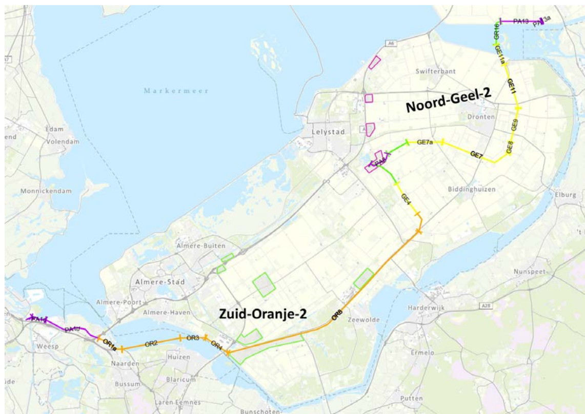
Figuur 2.2 Uitsnede met daarop de referentielijn van Zuid-Oranje-2, tussen het bestaande hoogspanningsstation Diemen en het meest zuidelijke locatiealternatief voor hoogspanningsstation Lelystad. En de referentielijn Noord-Geel-2 verder vanaf het meest zuidelijke locatiealternatief voor hoogspanningsstation Lelystad naar het bestaande hoogspanningsstation Ens
