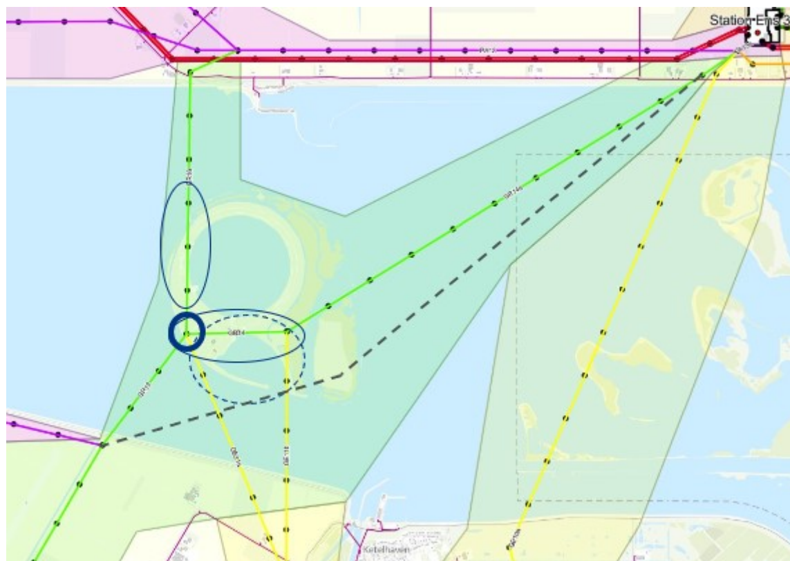
Figuur 8.17: Voorstel voor wijzigingen in de tracés over het ketelmeer, stippellijnen.
