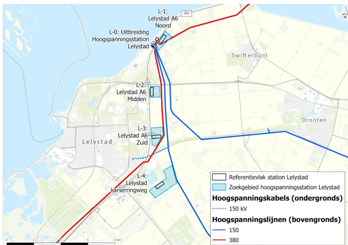
Figuur 6.3: Potentiële stationslocaties 380kV-station Lelystad, gelabeld als L-1 tot en met L-4. Een eventuele uitbreiding van het bestaande station krijgt het label L-0.
