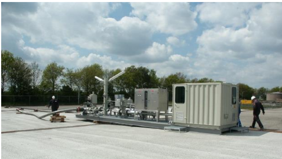
Figuur 2.4 Voorbeeld van een productie-eenheid op een productielocatie (bron: MER Gasboring en gaswinning Ternaard)
