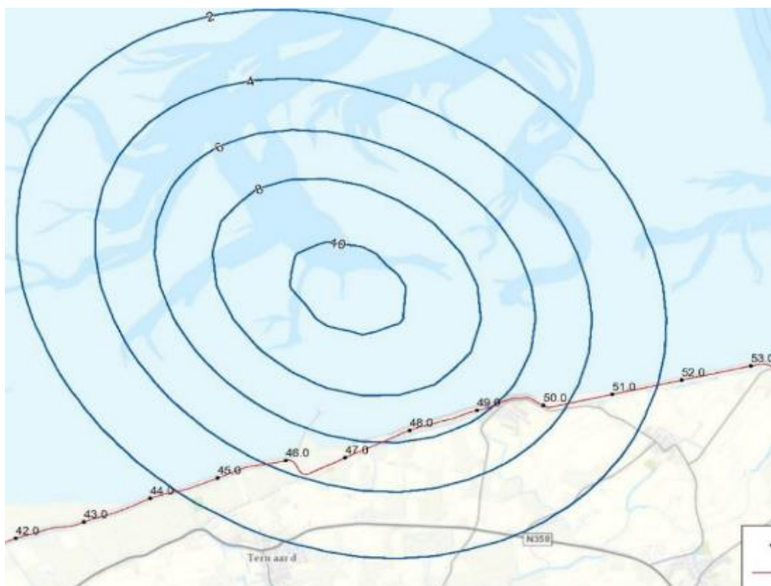
Figuur 5.26. Verwachte bodemdalingscontouren bij maximale winning ("High Case") (bron: MER Gaswinning en gasboring Ternaard)
