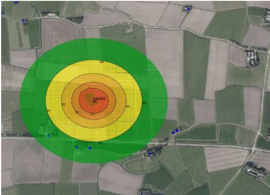
Figuur 5.11. Geluidscontouren heiwerkzaamheden in dagperiode op productielocatie (bron: MER Gaswinning en gasboring Ternaard)
