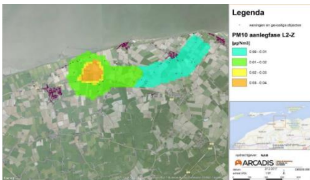
Figuur 5.28. Jaargemiddelde concentratiebijdrage PM 10 in aanlegfase productielocatie en leidingtracé (bron: MER Gaswinning en gasboring Ternaard)
