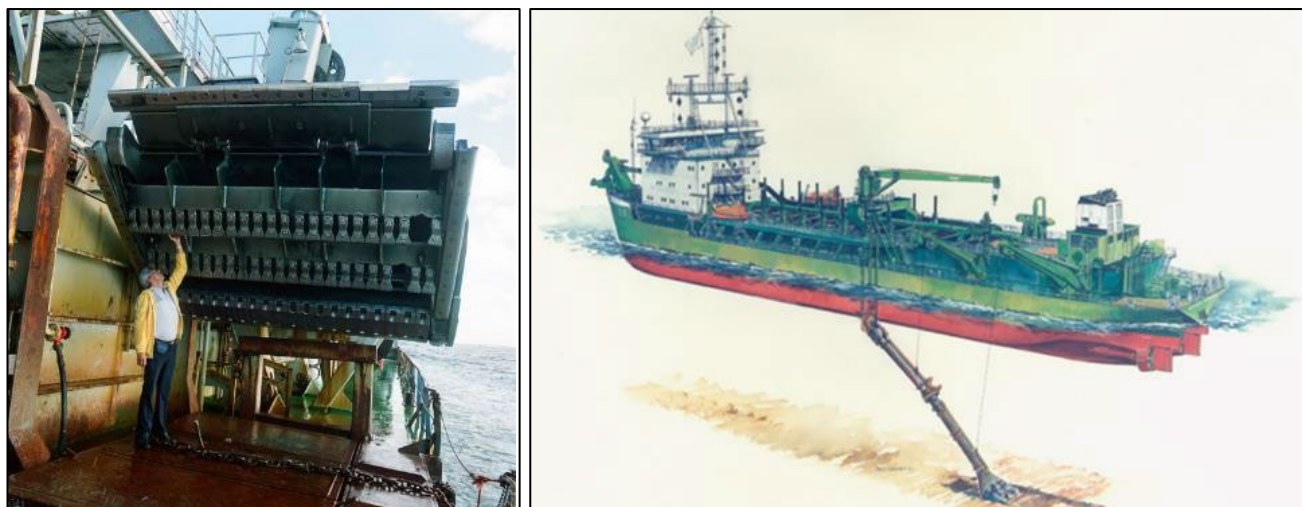
Figuur 3-4 Links: Foto van de sleepkop van een sleephopperzuiger (bron: beeldbank RWS). Rechts: Zijaanzicht van een sleephopperzuiger in werking met neergelaten sleepkop (bron: edugis.nl).
