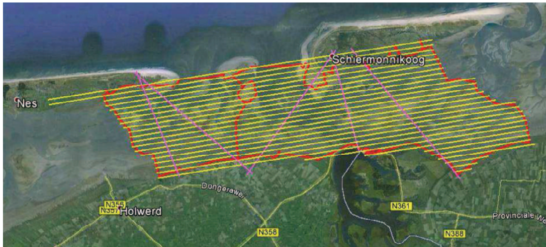
Figuur 4: Vluchtlijnen voor het uitvoeren van de LIDAR-opname in Pinkegat en Zoutkamperlaag (geel). De blauwe vluchtlijnen dienen ter controle en kalibratie van de LIDAR-opname. Deze lijnen verbinden vaste reflectiepunten op het land waarvan de hoogte bekend is. Ontleend uit FUGRO rapport ASM11085.
