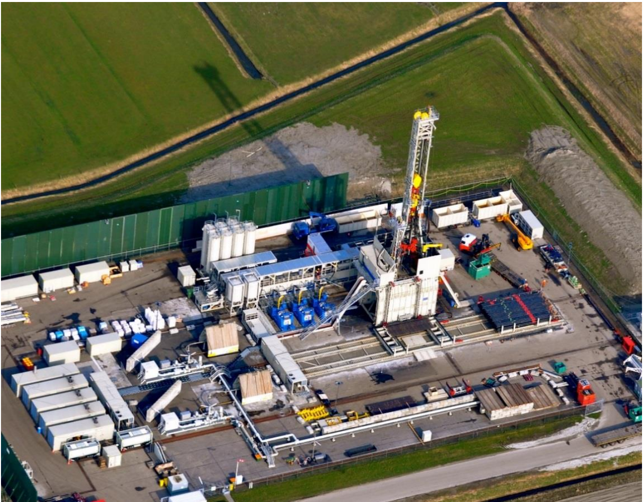
Figuur 2-2 Boorinstallatie inclusief boortoren en geluidswanden, zoals deze op de productielocatie eruit zal zien. Deze installatie staat meestal enkele maanden op locatie
