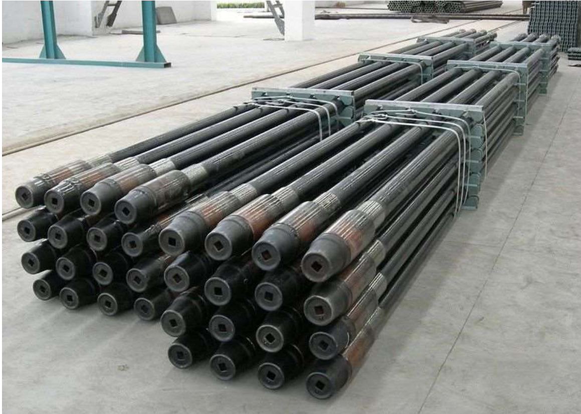
Foto 1: stalen palen diameter 140mm, lengte 9 meter
