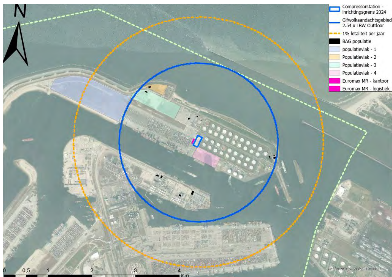
Figuur 8-5 Berekende aandachtsgebieden voor het compressorstation – Productie naar Aramis zeeleiding
