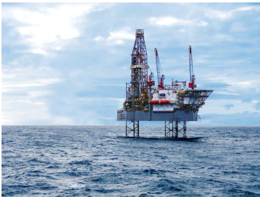
Figuur 9-4: Valaris 120 jack-up drilling rig (bron: Valaris.com )
