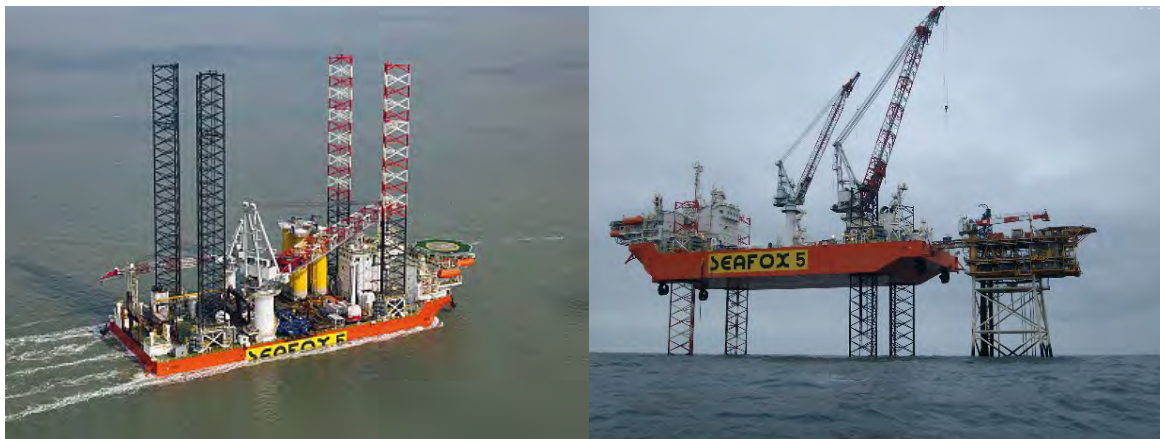
Figuur 9-3: Foto's van Seafox 5 jack-up lift vessel varend (links) en opgezet naast een gasproductie platform (bron: www.seafox.com ).
