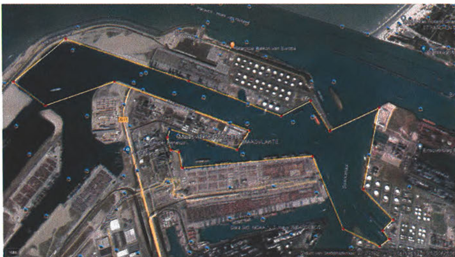
Figuur 6-2 Omtrek oppervlakte Havengebied op basis waarvan een realistische schatting is gemaakt van de mijdingsoppervlakte van 9 km door het heien van de aanlegsteigers, rekening houdend met de geometrie en reflectie van het onderwatergeluid op de oevers.
