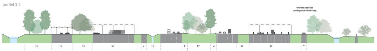
Afbeelding 3.8 Dwarsprofiel verzorgingsplaatsen [ref. 2]
