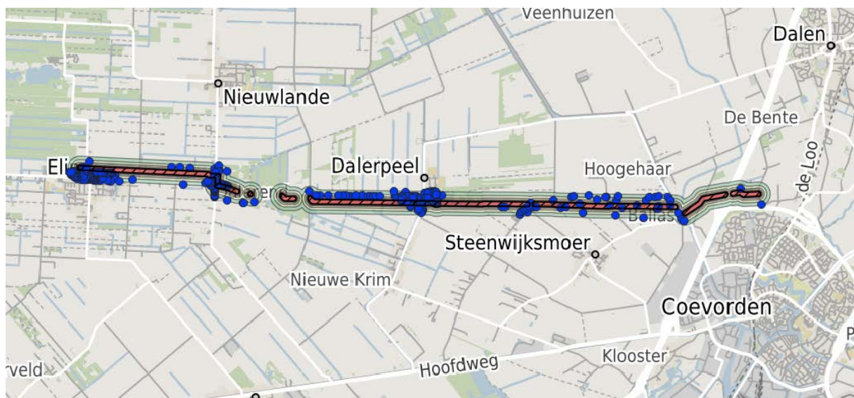
Figuur 14. Overzicht van woningen (in blauw) bij het verwijderen van de bestaande leiding (met een onzekerheidsmarge van 30 m) met contouren op 10, 30, 55, 95 en 150 meter.
