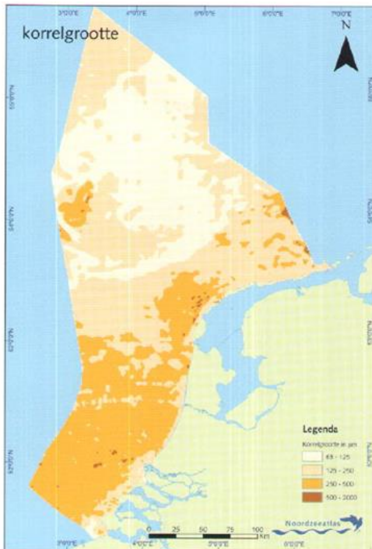
Afbeelding 3.11 Korrelgrootte van het sediment dat zich aan het oppervlak (bovenste meter) van de zeebodem bevindt. Bron: Noordzee-atlas (2004)
