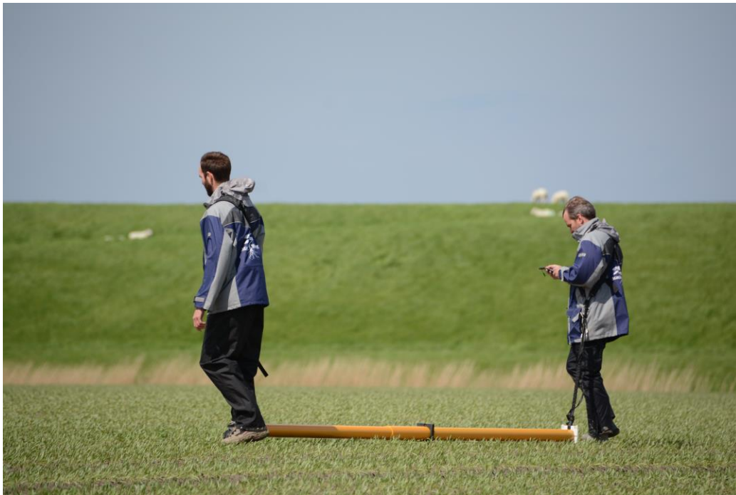
Figuur 6. FDEM (DUALEM) meting
