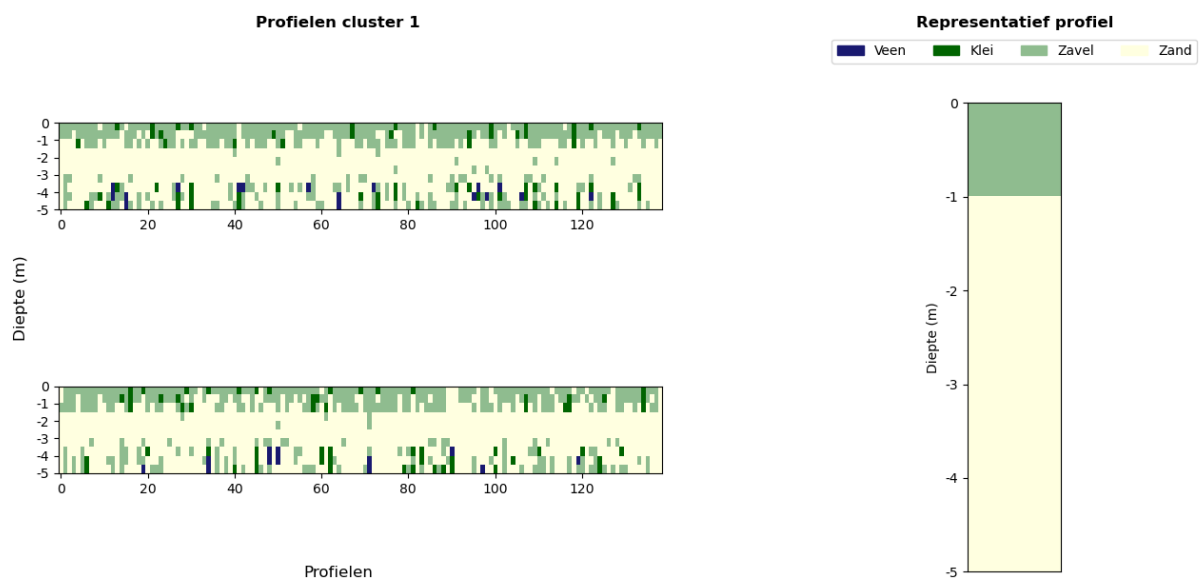
Figuur 6. Voorbeeld van alle bodemprofielen (links) die worden vertegenwoordigd door cluster 1 (rechts).
