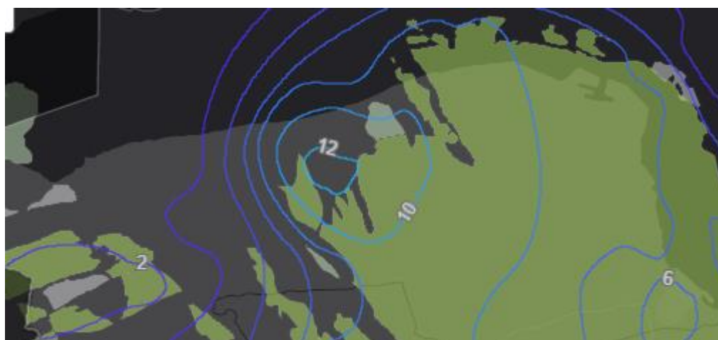
Figuur 10. Bodemdaling prognose voor de periode 2020-2050 in cm uitgaande van gas- en zoutwinning (bron:
