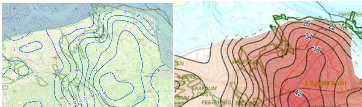
Figuur 9. Bodemdaling tot 2018 (links) en prognose van totale bodemdaling tot 2050 (rechts) in cm uitgaande van aardgaswinning (bron: NAM 2020).
