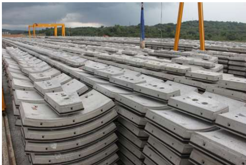
Figuur 2-12 Opslag tunnelsegmenten
