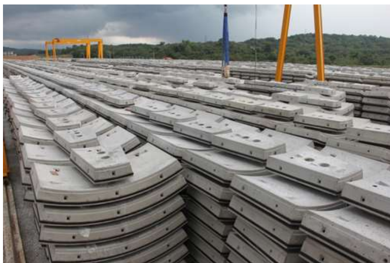
Figuur 2-12 Opslag tunnelsegmenten
