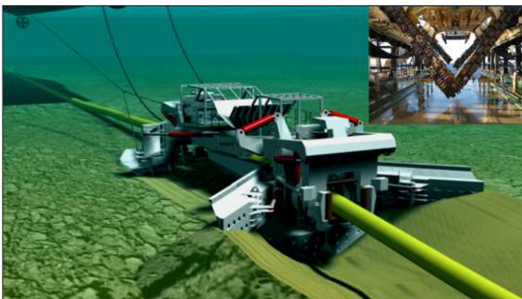
Figuur 2-4 Voorbeeld ploeg voor begraven pijpleiding
