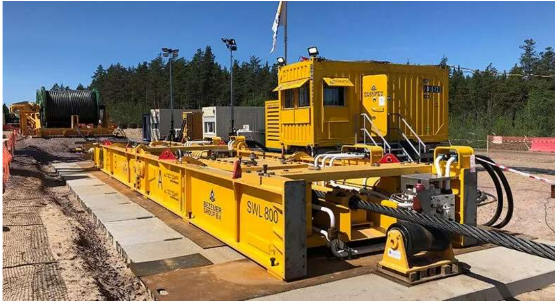
Figuur 2-15 Bezemer 800 ton lier ( https://bezemer.com/products/linear-winch/ )
