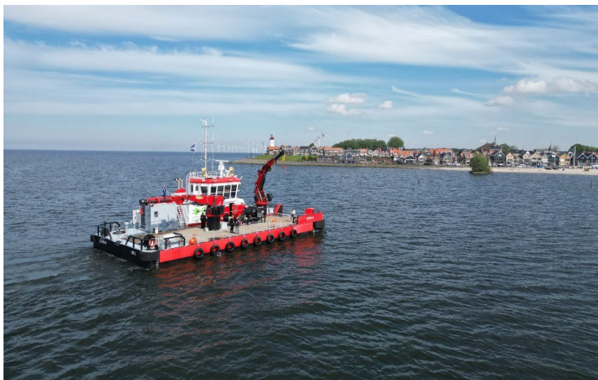
Figuur 3-16 - Voorbeeld van een werkboot die gebruikt wordt voor het verzetten van ankers
