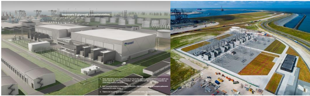
Abbildung 3.6 Konverterstation (links) und Umspannwerk (rechts)
