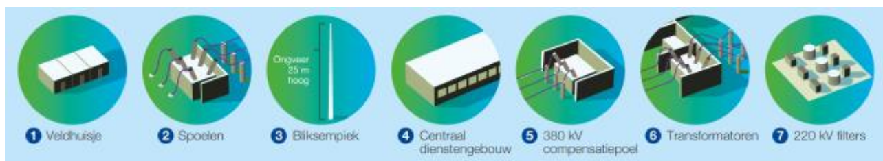
Afbeelding 33. Indicatieve weergave van onderdelen transformatorstation
