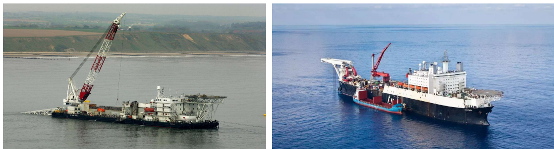
Figuur 2-1 Pijpleggerschepen – op ankers (l) en Dynamic Positioning (r)
