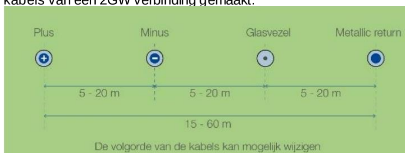
Afbeelding 31b. Een 2 GW-kabelsysteem HDD-kruising primaire waterkering
