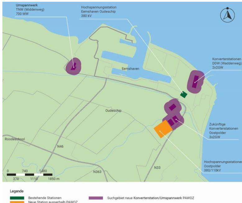
Abbildung 13: Bestehende und vorgesehene Hochspannungsstationen im und rund um den Eemshaven
