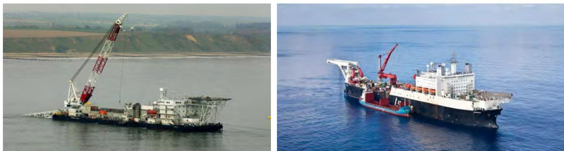
*Figuur 2-1 Pijplegschepen – op ankers (l) en Dynamic Positioning (r)*
