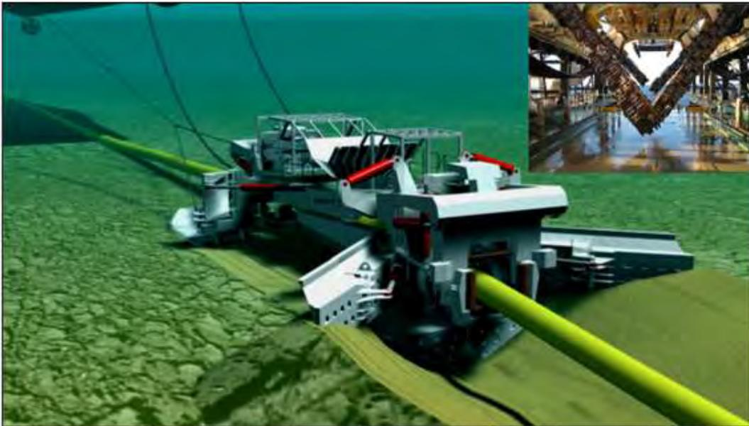
*Figuur 2-4 Voorbeeld ploeg voor begraven pijpleiding*
