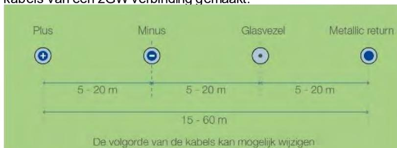
Afbeelding 31b. Een 2 GW-kabelsysteem HDD-kruising primaire waterkering
