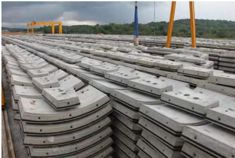
*Figuur 2-12 Opslag tunnelsegmenten*
