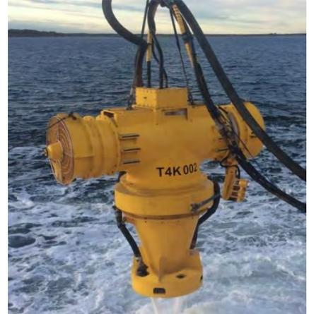
Afbeelding 12. Controlled Flow Excavator
