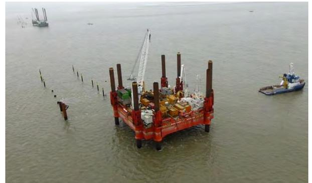
Afbeelding 18. Jack-up barge Wavewalker
