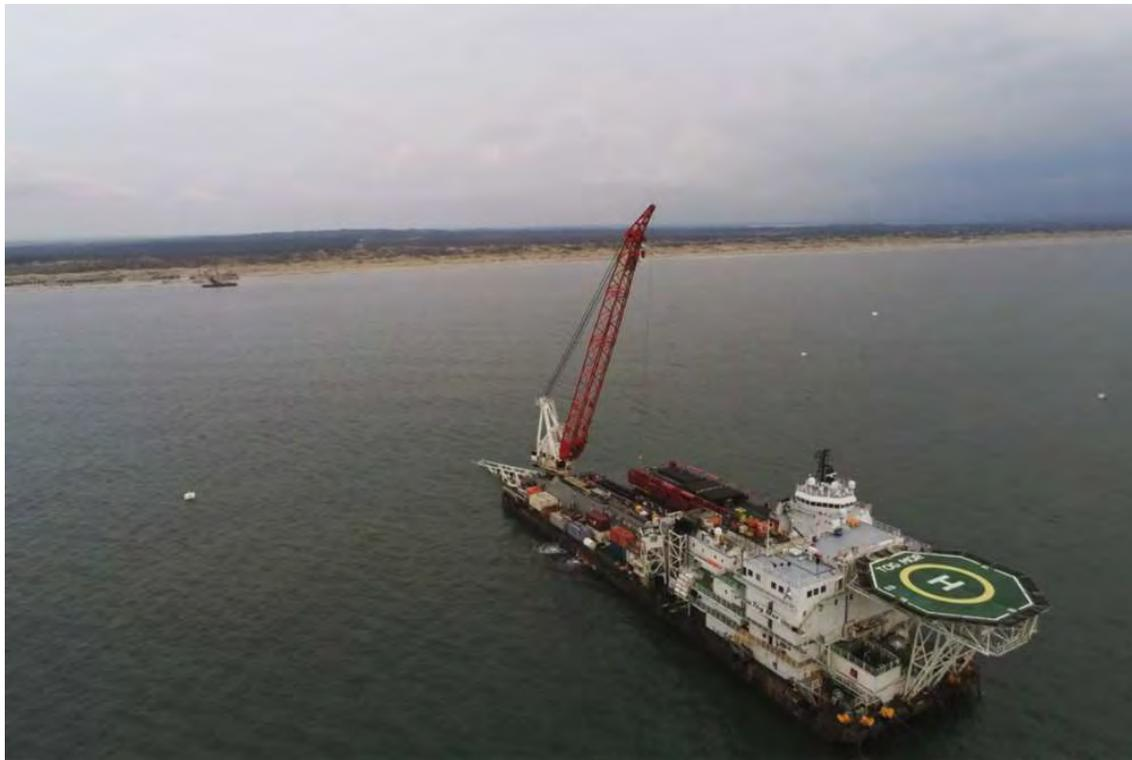
*Figuur 2-14 Allseas Tog Mor bij Houstrup Denemarken aanlanding Europipe II branch line, intrekken pijpleiding*
