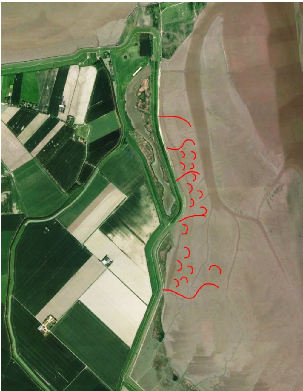
Figuur 2-5: Het projectgebied met daarin het ontwerp van de rijshoutendammen (rode lijnen). Wat betreft de meest zuidelijke dam wordt opgemerkt dat hier enkele zeer kleine geulen liggen. Men dient er hier rekening mee te houden dat het water hier mogelijk door of onder de rijshoutendammen heen zou kunnen stromen.
