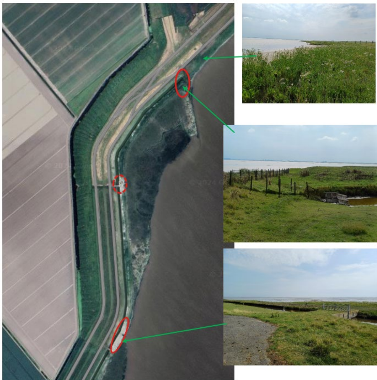
Figuur 2-10 Locatie van potentiële werklocaties (rode cirkels), hier is de typische kweldervegetatie niet of nauwelijks aanwezig, doordat deze vertrapt is door vee, opgehoogd is en/of een dam en verdrinkplek aanwezig is.
