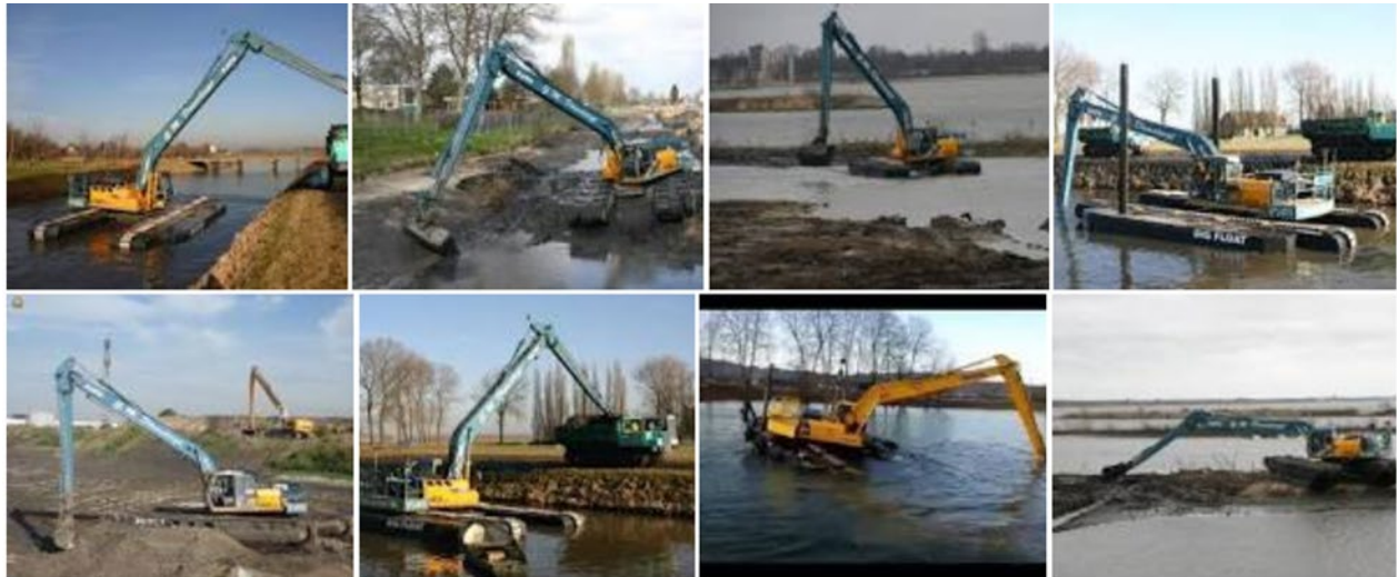
Figuur 2-8: Voorbeelden van materieel geschikt voor werken op water en slappe bodem
