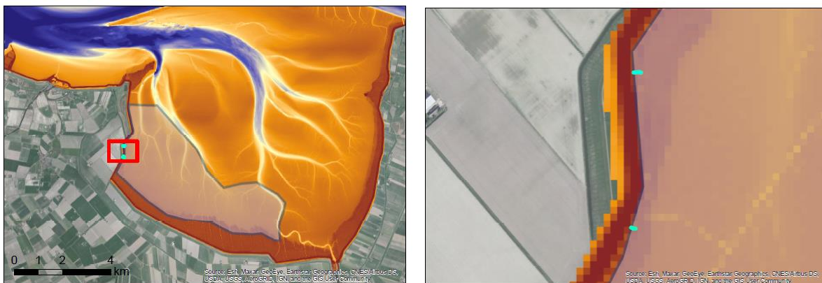
Figuur 1: [Links] De grijze polygoon geeft het gebied aan waarvoor een KLIC-melding is uitgevoerd. Alleen binnen de rode rechthoek zijn leidingen gevonden. [Rechts] Uitvergroting van de rode rechthoek met daarin aangegeven de ligging van de leidingen.
