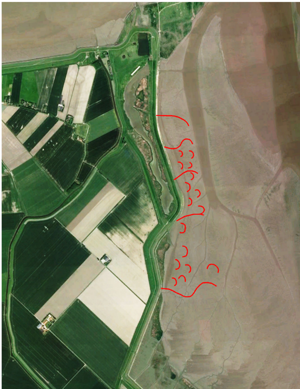
Figuur 4: Het projectgebied met daarin het ontwerp van de rijshoutendammen (rode lijnen). Wat betreft de meest zuidelijke dam wordt opgemerkt dat hier enkele zeer kleine geulen liggen. Men dient er hier rekening mee te houden dat het water hier mogelijk door of onder de rijshoutendammen heen zou kunnen stromen.
