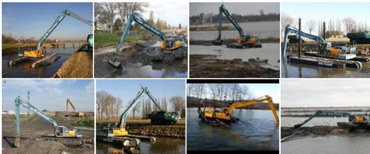
Figuur 6: Voorbeelden van materieel geschikt voor werken op water en slappe bodem
