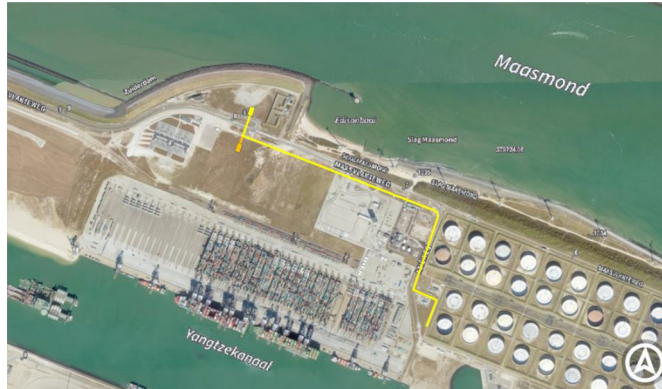
Figuur 2.7 Tracé van de zeeleiding op land (gele lijn) vanaf het mengpunt bij het Porthos compressorstation naar het startpunt van de kruising onder de zeewering en Maasgeul.
