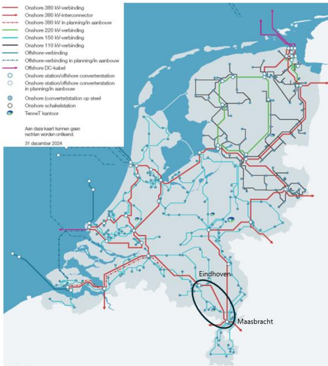
Afbeelding 2.2 Het 380- en 220 kV-net per 31-12-2024 (bron: TenneT, 2024)
