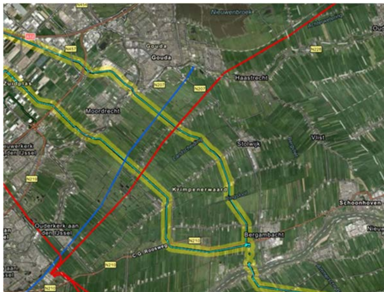
Afbeelding 1: Onze rivierwaterleidingen (lichtblauw met gele band) en de tracés van de 380 kV-leidingen (rode en blauwe lijnen)
