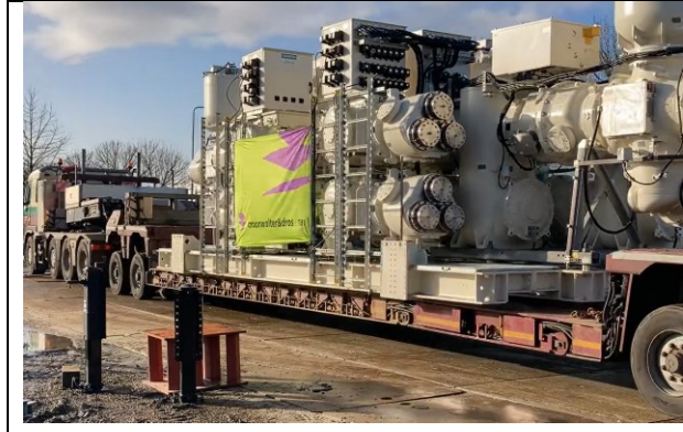
Afb. 2.4: aanzicht van MGU op een oplegger.
