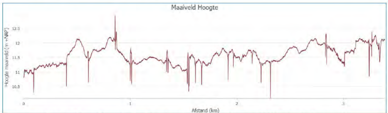
Figuur 3.1 AHN hoogteprofiel vanaf de aansluiting op de basisvariant (links, westzijde) tot aan S-356 Vlieghuis (rechts, oostzijde).
