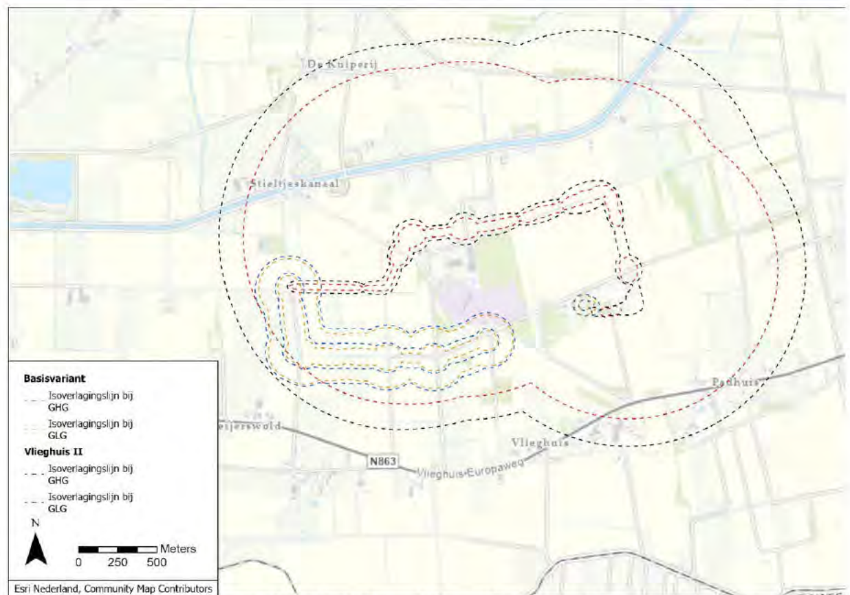
Figuur 6.2 Vergelijking tussen het freatische invloedsgebied tussen tracévariant Vlieghuis II en de basisvariant. De isoverlagingslijnen weergegeven, geven de grondwaterstandverlagingen van 0,5 m en 0,05 m aan.
