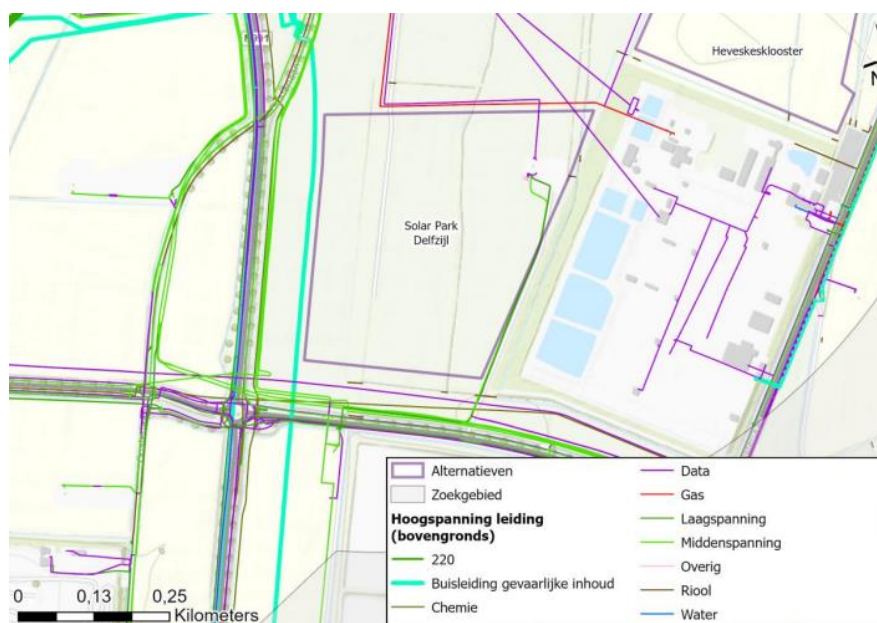
Figuur 0-1 Analyse onder- en bovengrondse kabels en leidingen locatie Solar Park Delfzijl (bron: Haalbaarheidsstudie Netuitbreiding 220/110kV-station Delfzijl Weiwerd)
