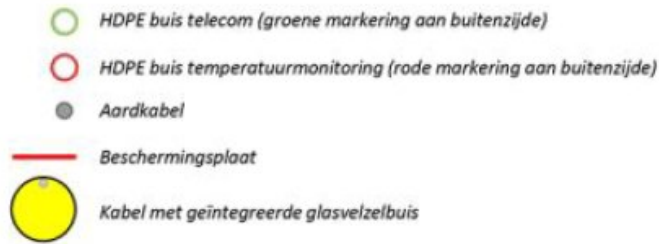
Afbeelding 4.2 Legenda richtlijn configuratie 2 parallelle circuits 110/150 kV
