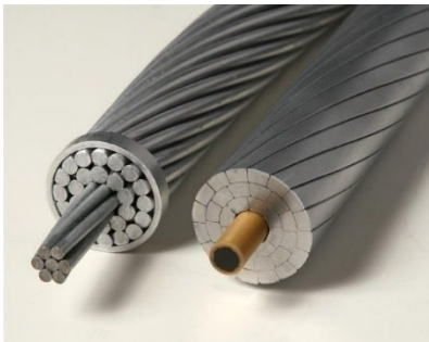
Figuur 2: geleider van staal (links) en geleider met carbonkern (rechts) 1
