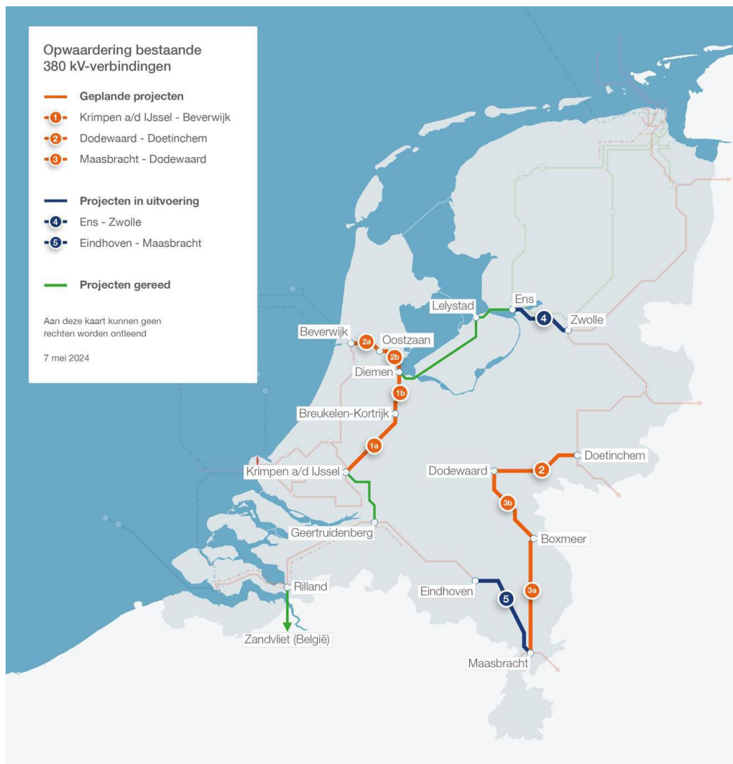
Figuur 3: Opwaarderingsprojecten bestaande 380kV-verbindingen
