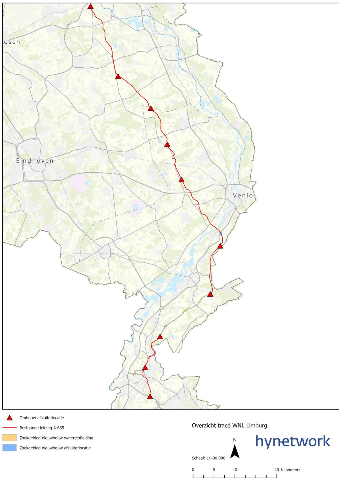
Afbeelding 9 – ombouw afsluiterlocatie tussen Ravenstein en Schinnen
