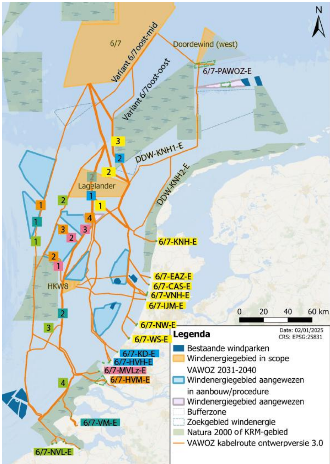
Figuur 1-9 Overzicht elektrische routes Noordzee en grote wateren uit zoekgebied 6/7, Doordewind en HKW8. De alternatieven voor iedere route zijn aangegeven met een cijfer in dezelfde kleur
