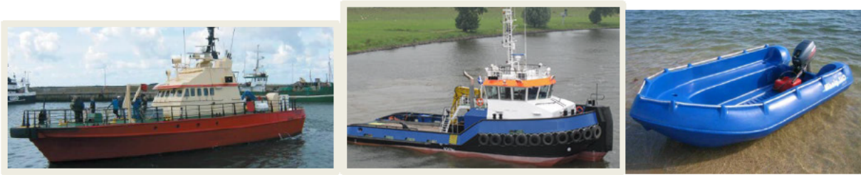
Figuur 3-15 Afbeelding guard vessel (links), werkboot voor het verplaatsen van de ankers (midden) en kleine werkboot dat kan stranden (rechts).
