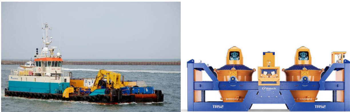
Figuur 3-14 Multicat (links) en CFE systeem (rechts)
