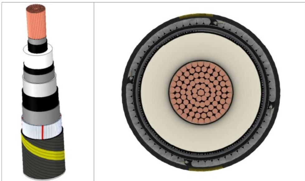
Figuur 2-4 Schematische weergave HVDC en DMR kabels
