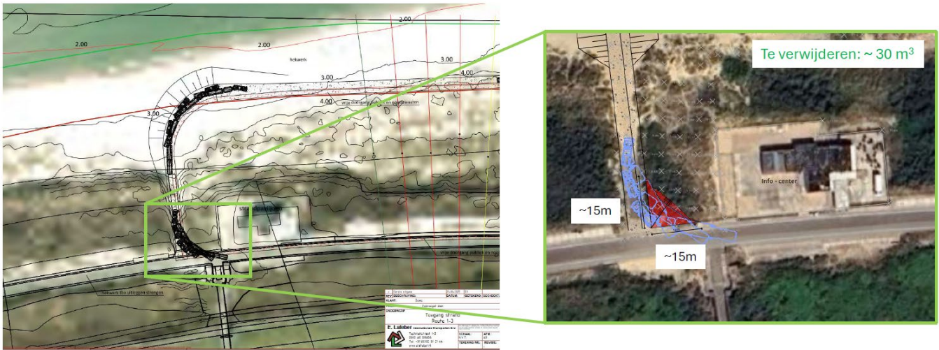
Figuur 3-6 Bochtverflauwing dijkopgang voormalig strandpaviljoen View
