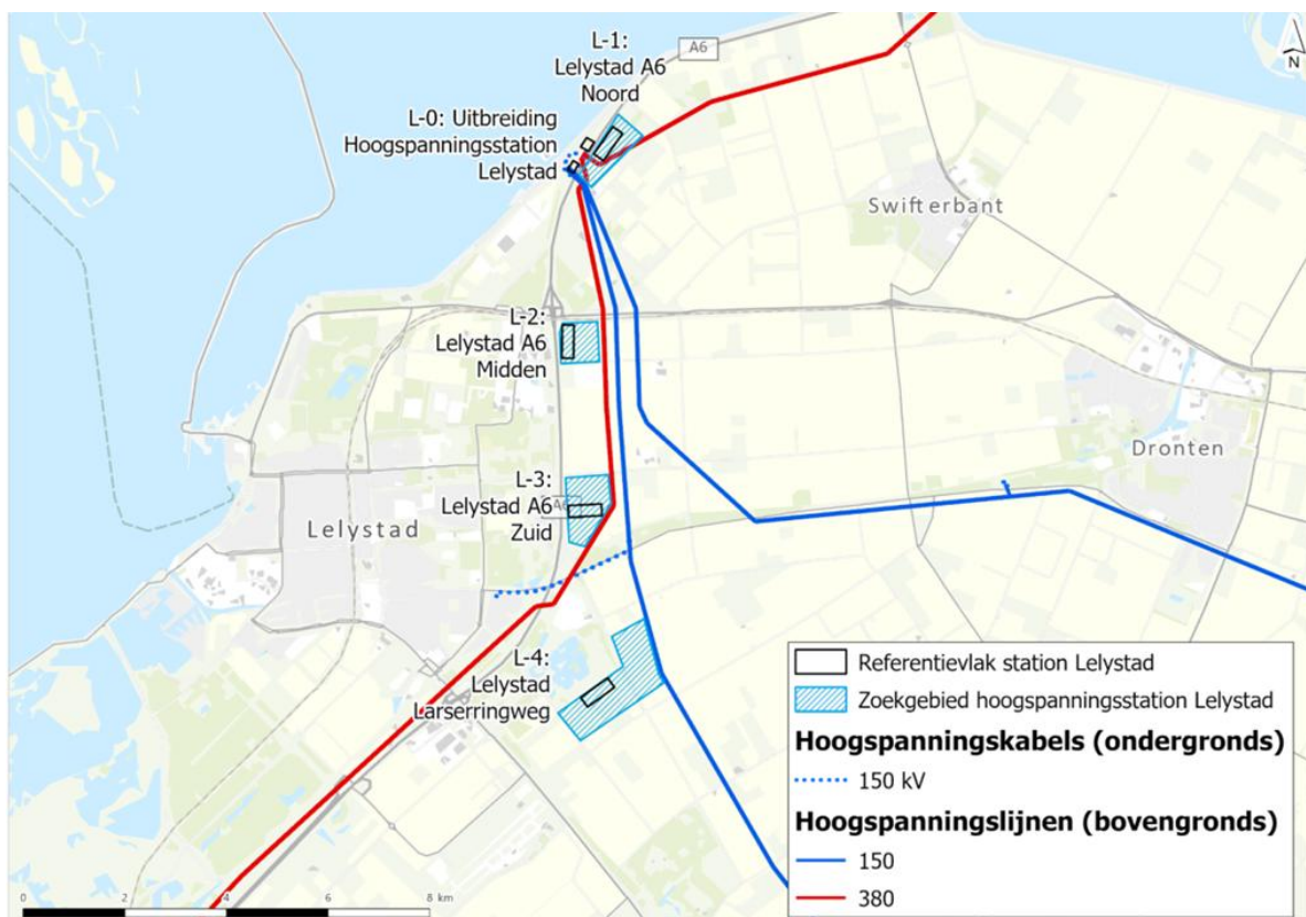
Figuur 6-5: Potentiële stationslocaties 380kV-station Lelystad, gelabeld als L-1 tot en met L-4. Een eventuele uitbreiding van het bestaande station krijgt het label L-0.
