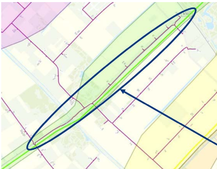
Figuur 8-8: Tracédeel GR5 met nabijgelegen buisleiding.
