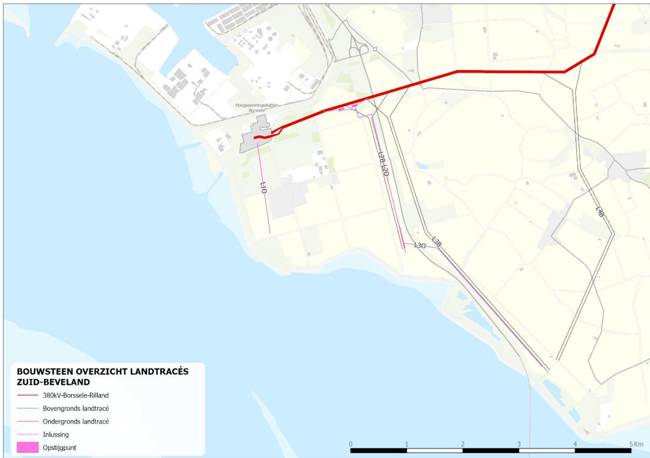
Figuur 3-4 Landtracés Zuid-Beveland. Van links naar rechts: L10. Vervolgens L2B en L2O, deze volgen nagenoeg hetzelfde tracé. Rechts daarnaast: L3B en L3O. L3O maakt ook gebruik van het tracé van L2O en doorkruist met een gestuurde boring de N-weg. Aan de rechterzijde L4B
