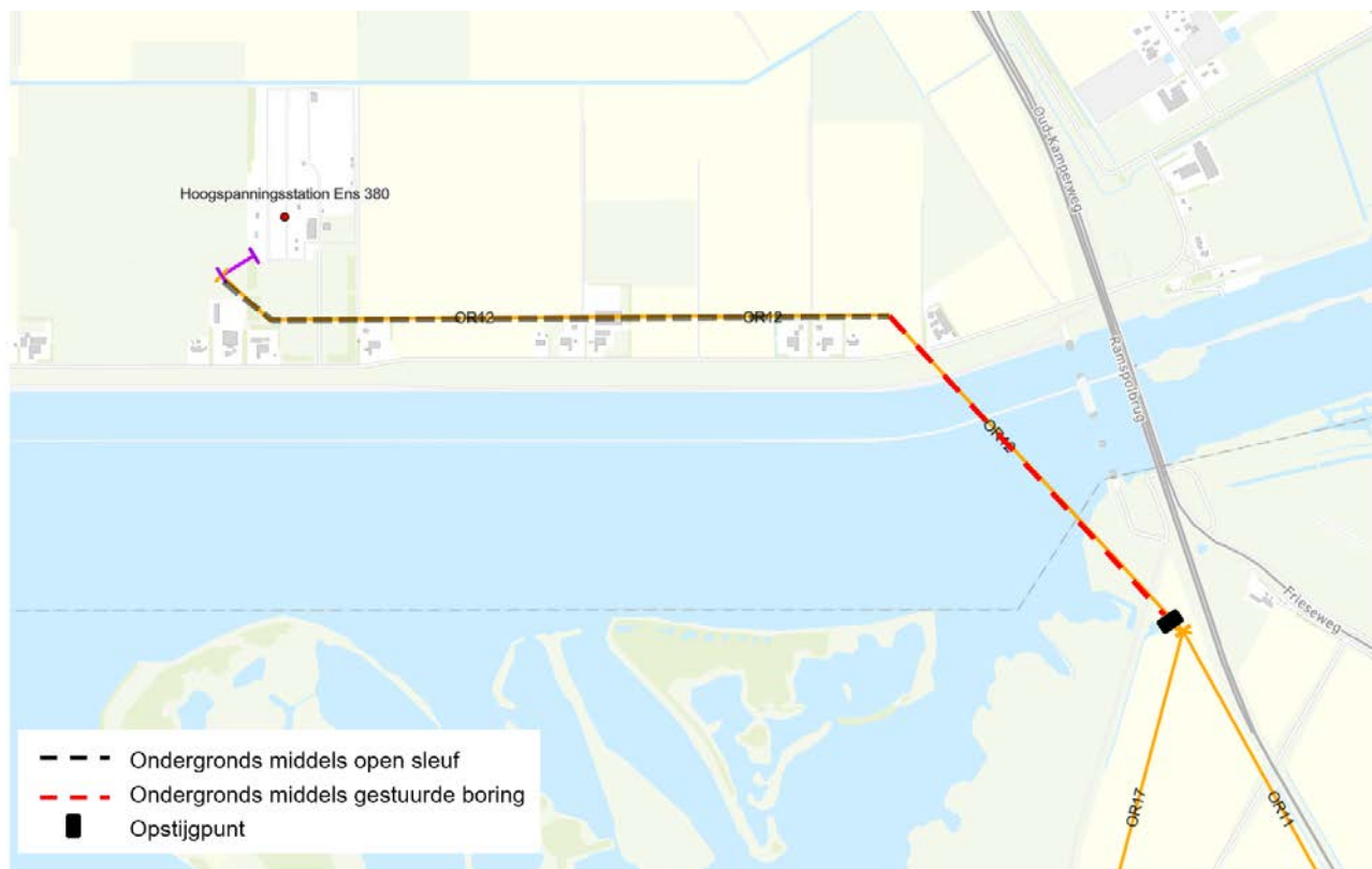
Figuur 2.9 Situatie ondergrondse aanleg bij deeltracé OR12
