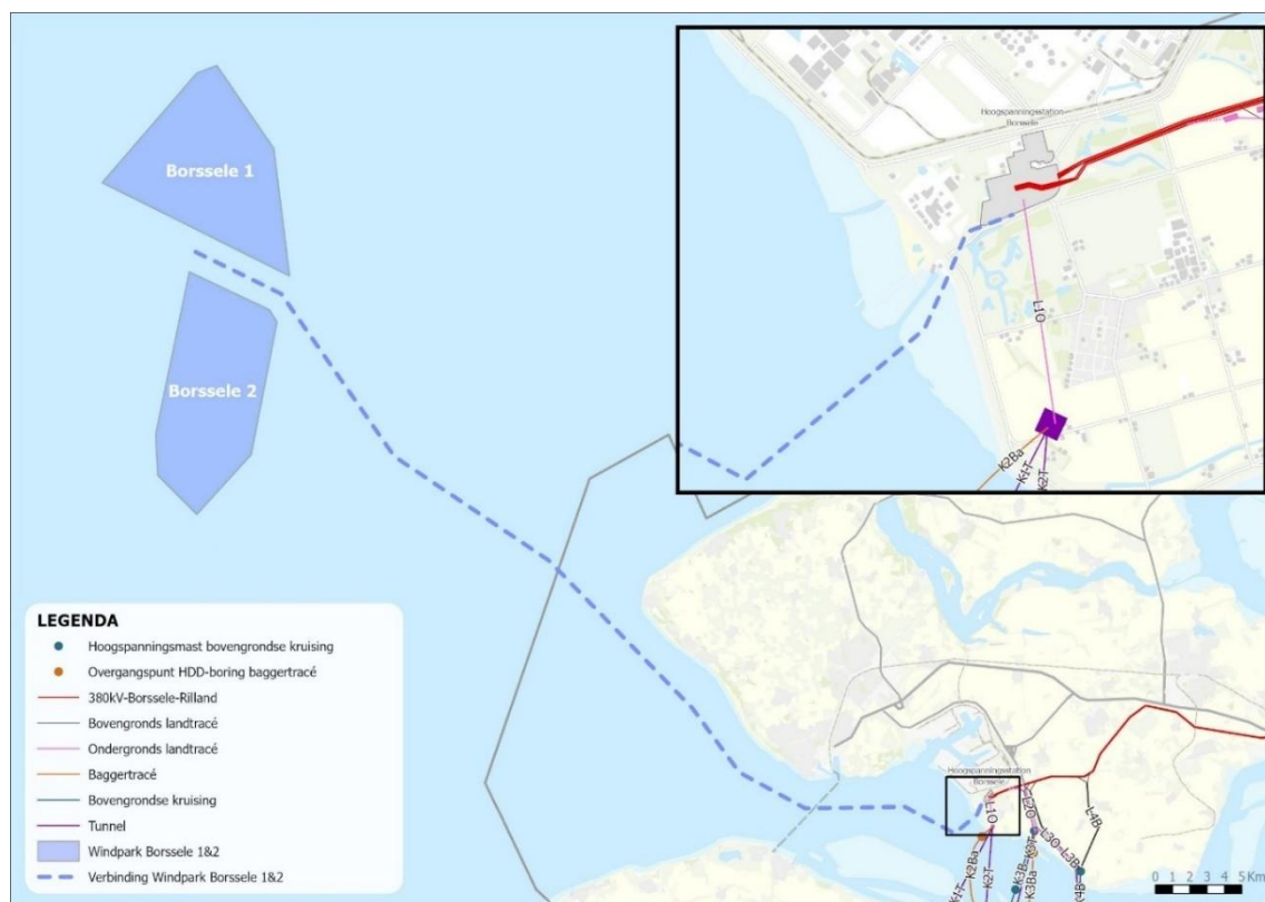
Figuur 5-6 Landtracé L10 en de verbinding vanaf Windpark Borssele 1&2. In de uitsnede is het tracé van de offshore landstationkabels te zien.
