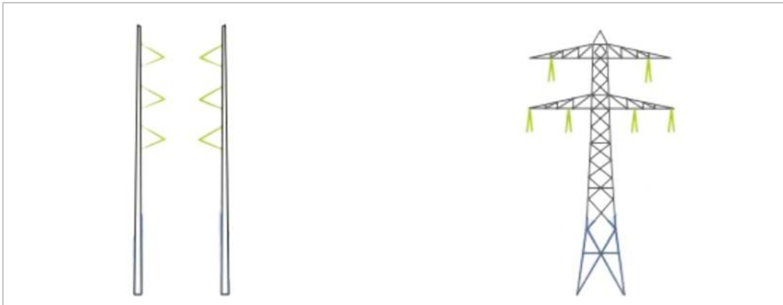
Figuur 1.4 Illustratie wintrackmast (links) en vakwerkmast (rechts)
