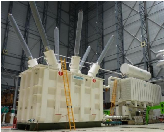
Figuur 3.7: Een seriespoel links met een koelunit rechts
