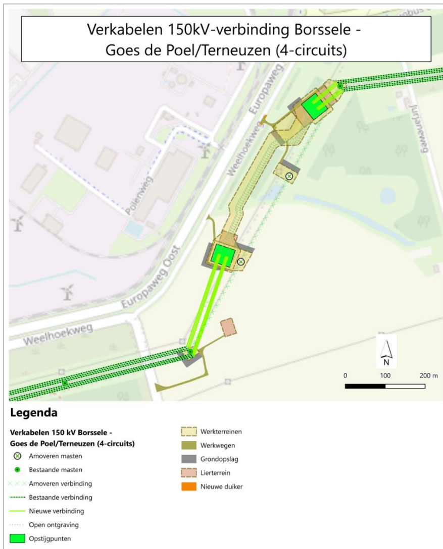
Figuur 2-6: Verkabelen 150kV-verbinding Borssele – Goes de Poel/Terneuzen
