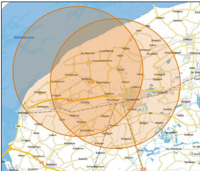
Figuur 2.6 Gebieden waar bouwwerken het radarbeeld kunnen verstoren
